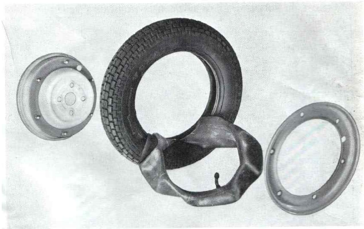
Fig. 11 - Smontaggio pneumatico
