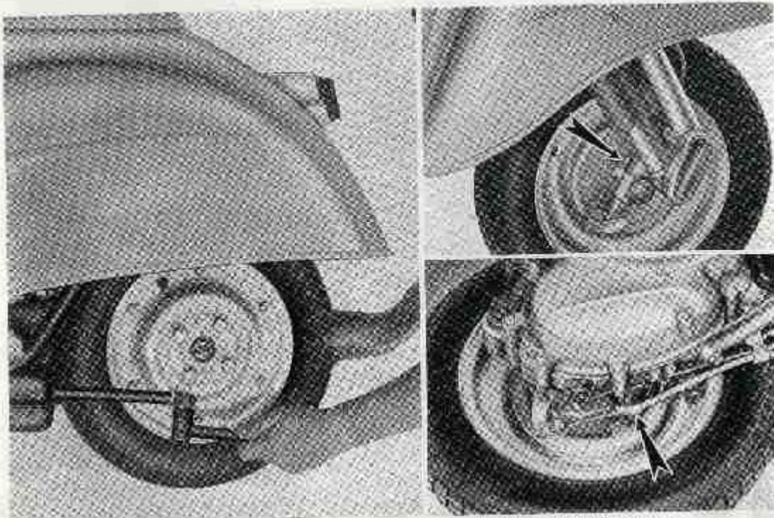
Fig. 9 - Smontaggio ruote dal veicolo
