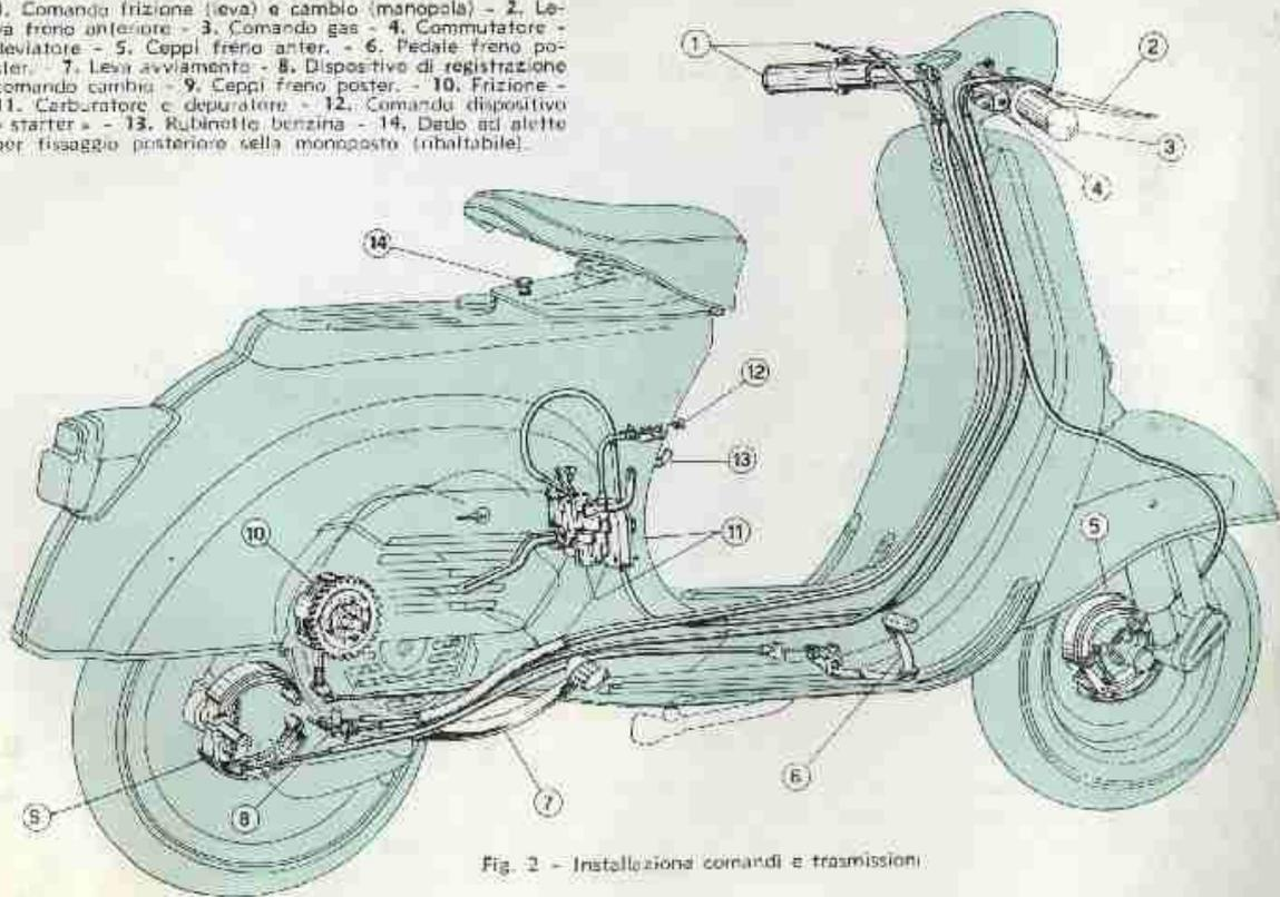
Fig. 2 - Installazioni comandi e trasmissioni.
