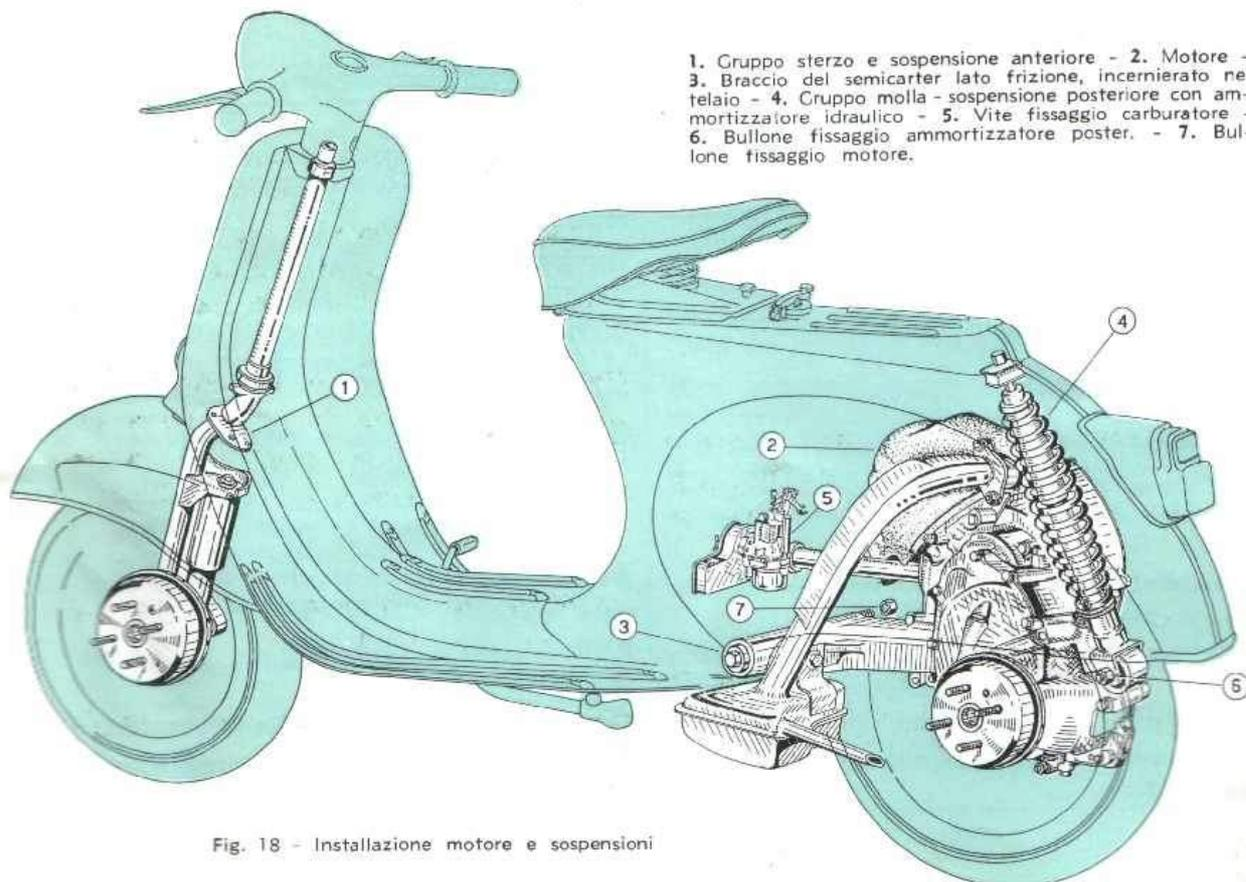
Fig. 18 - Installazione motore e sospensioni
