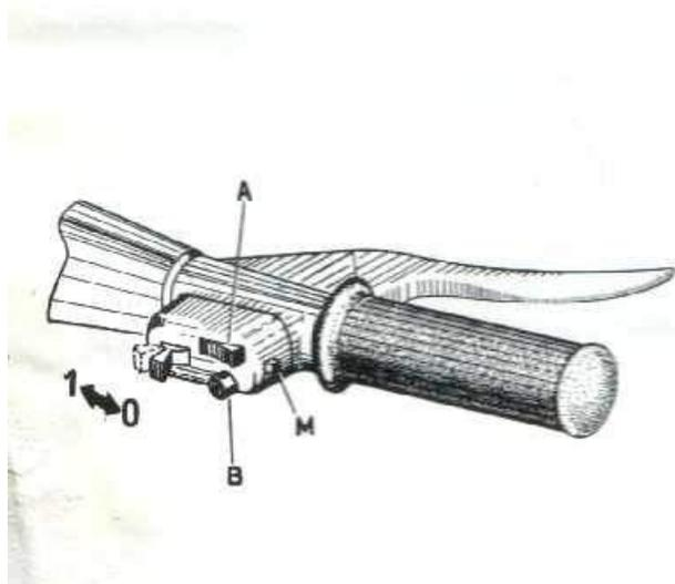
Fig. 21 - Posizioni del commutatore
