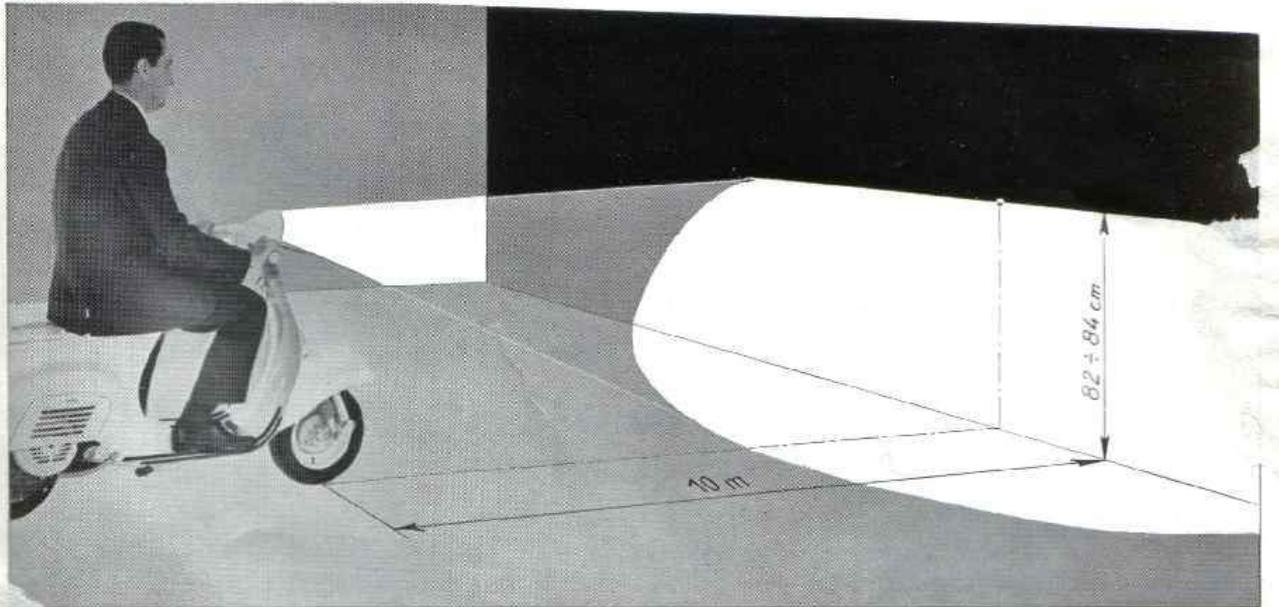
Fig. 14 - Schema orientamento proiettore
