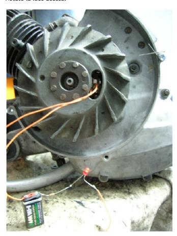
Facendo attenzione che le 2 tacche del volano rossa e nera coincidano, dobbiamo ruotare lo statore fino al momento in cui il led non si spegnerà. quello è il momento in cui le punte iniziano ad aprirsi e scoccare la scintilla. Mi raccomando attenzione che l'apertura massima delle punte sia 0.4 mm. Appena la luce si spegne, fissiamo lo statore, e quello sarà il nostro anticipo corretto. Ricolleghiamo i fili, regoliamo le punte mettiamo il volano e serriamo tutto. Fine
